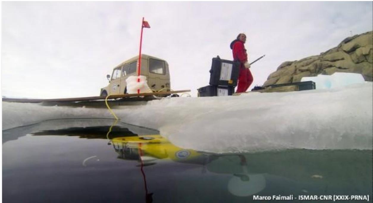
*Il mini-ROV viene finalmente immerso nel foro di immersione*
