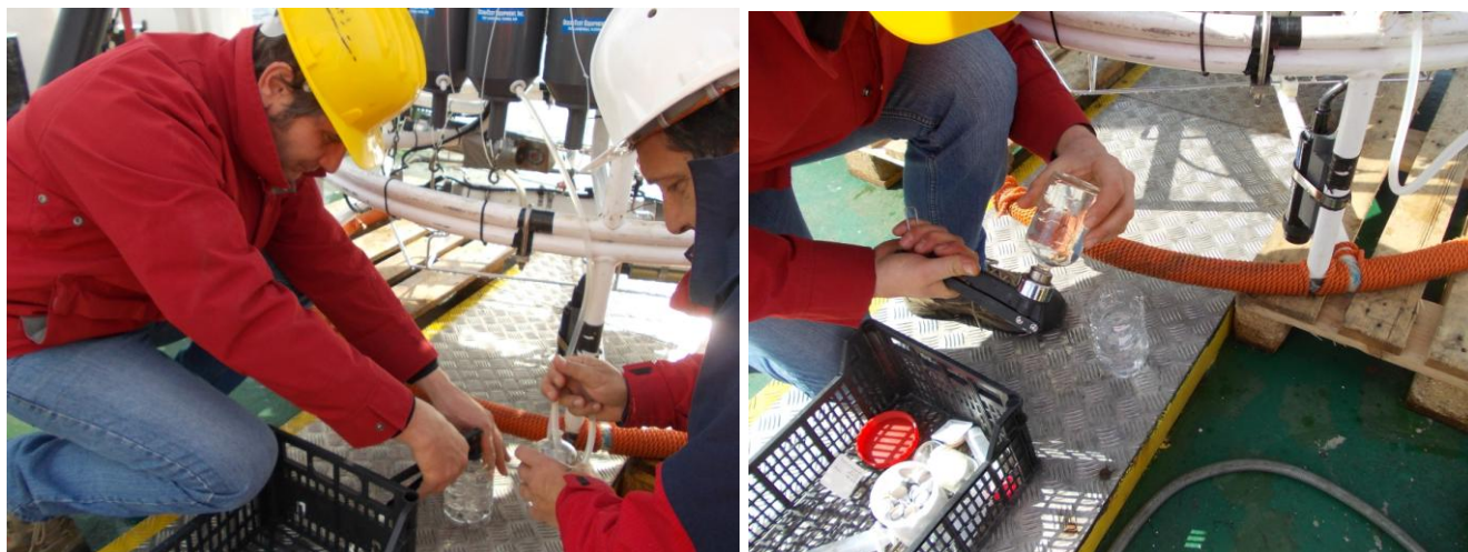
Foto 3 – Operazioni di campionamento delle acque (Sinistra) e chiusura delle bottigliette (destra).
