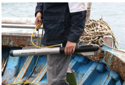
Figura 8. Towfish Sidescan Sonar utilizzato durante le due campagne di pesca.
