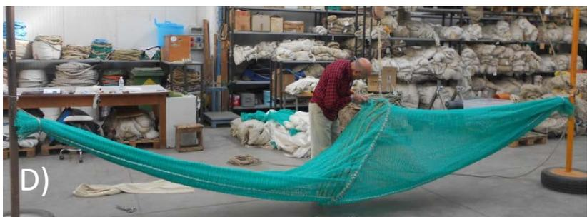
Figura 10. A) Griglia di esclusione “Super-shooter”. B) Dettagli tecnici relativi al montaggio del “Super-shooter” nell’avansacco della rete. C) Dettaglio dell’uscita realizzata sulla parte superiore dell’avansacco in corrispondenza della griglia D) Installazione della griglia nell’avansacco: nel montaggio si è cercato di mantenere un angolo di 45° rispetto all’asse longitudinale della rete.
