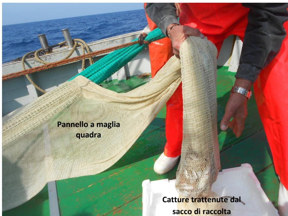
Figura 8. Dettaglio dell'avansacco dotato di pannello a maglia quadra da 50 mm (STPA50) e del sacco di raccolta degli individui riusciti a fuggire.
