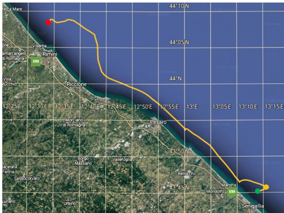
Figura 5. Tracciato GPS registrato dal sistema boa E1 tra il 13 marzo ed il 18 marzo 2021 (linea gialla), sito E1 (cerchio rosso), sito di ritrovamento del sistema del 17 marzo 2021 (cerchio giallo), sito di ormeggio provvisorio del sistema tra il 17 e il 18 marzo 2021 (cerchio verde). Mappa cartografica prodotta utilizzando Google Earth.
