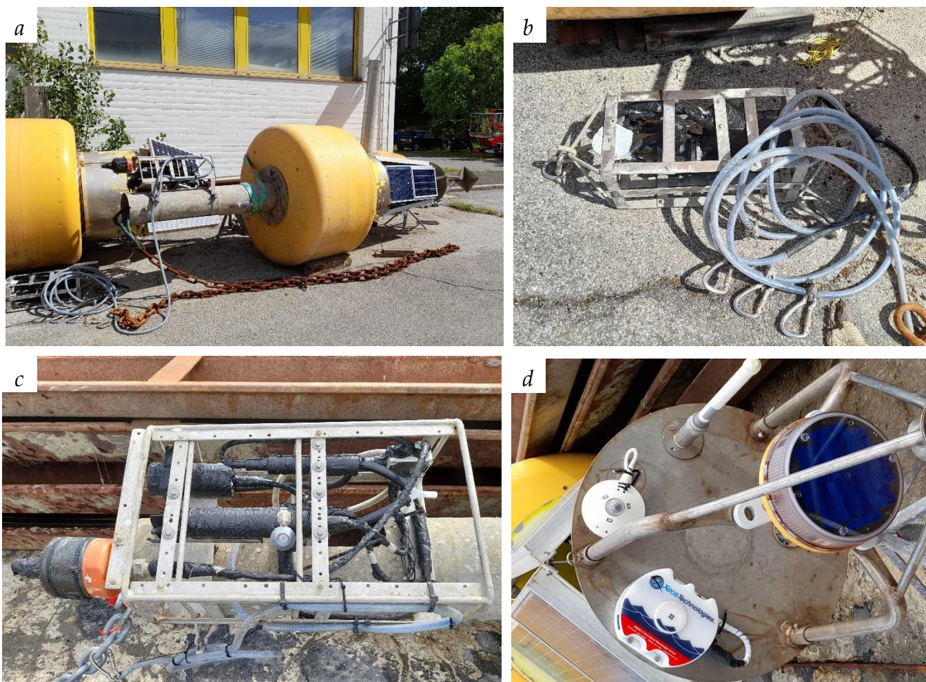
Figura 9. Boa E1 ricondizionata dopo manutenzione straordinaria (a), particolari del secondo livello sensori (b), particolare del primo livello sensori (c), nuovo faro di segnalazione (d)
