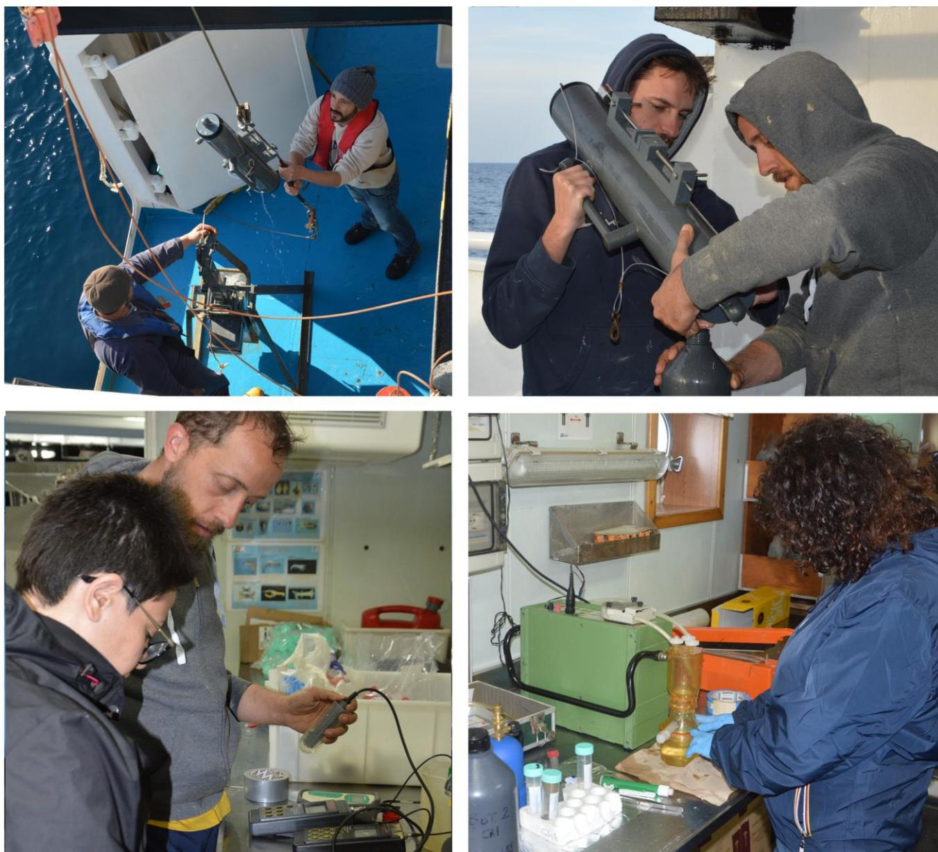
**Figura 11** – Fasi di prelievo acqua di fondo: recupero bottiglia Niskin, spillatura acqua da Niskin, misure parametri chimico-fisici acqua, filtraggio acqua per analisi microbiologiche
