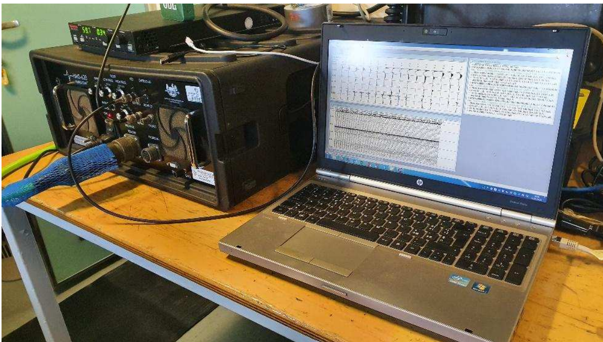
Figura 4b – Computer di acquisizione delle linee multicanale
