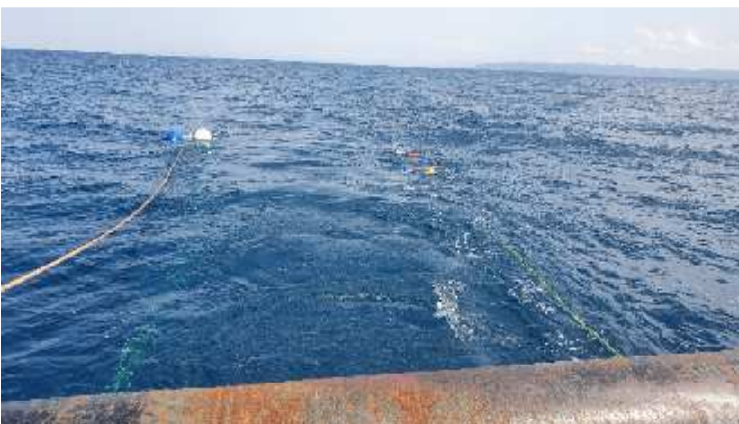
Figura 7 – Boomer e cavo sismico trainati a poppa
