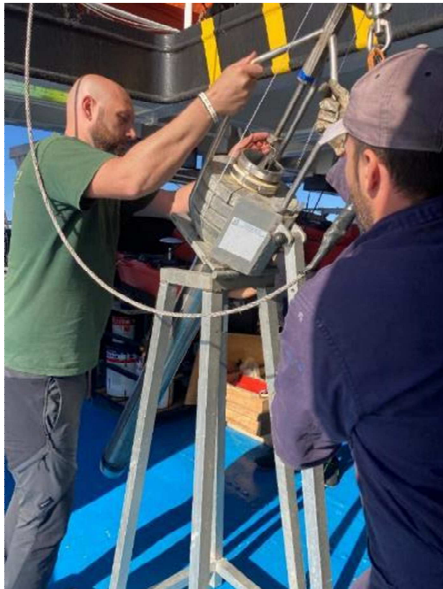
Figura 14a,b – Armamento e messa a mare del carotiere prima della calata
