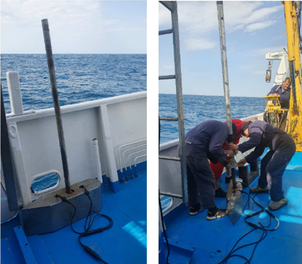
Figura 9 – I trasduttori del sistema CHIRP ed ecoscandaglio montati su un palo a murata.
