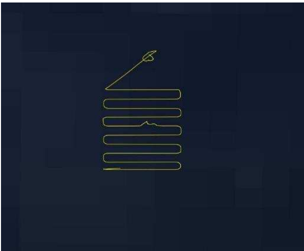
Figura 13: Risultato della navigazione SWAP. Si può notare la precisione del veicolo nel seguire la navigazione lungo la griglia pre-impostata. Il punto impreciso che si vede a metà acquisizione è dovuto ad un momento di test effettuato dall'operatore.
