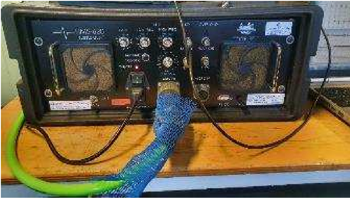
Figura 4a – Deck Unit della sorgente Bubble Gun
