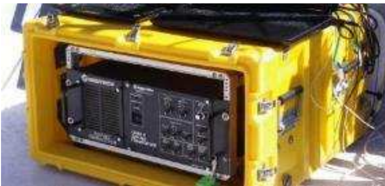
Figura 8 – Consolle di acquisizione del sistema CHIRP III Benthos-Teledyne collegato al computer di controllo e archiviazione dei dati.
