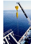
Pizionamento del carotiere a gravità per l'operazione di carotaggio
