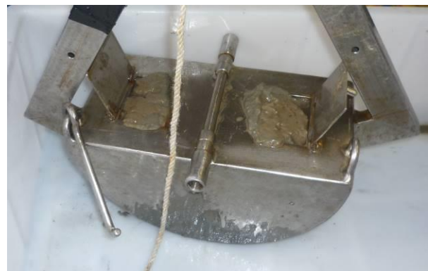
Figura 12 – Particolare della benna Van Veen: finestre di prelievo sedimento superficiale
